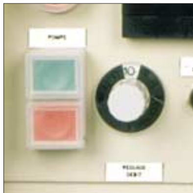
Il est possible de régler le débit de la pompe en tournant ce bouton
