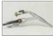
Lance de rejointoiement
