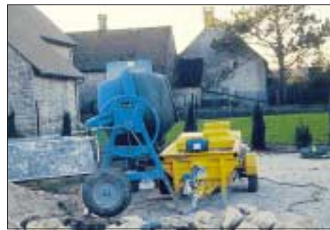
La S8 SMART avec une bétonnière
