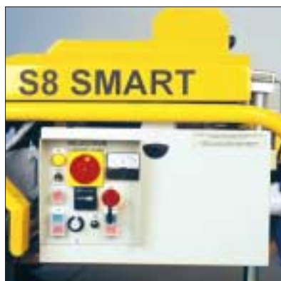
Il est possible de régler le débit de la pompe en tournant ce bouton
