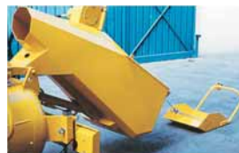
Benne de chargement avec pelle tractée
